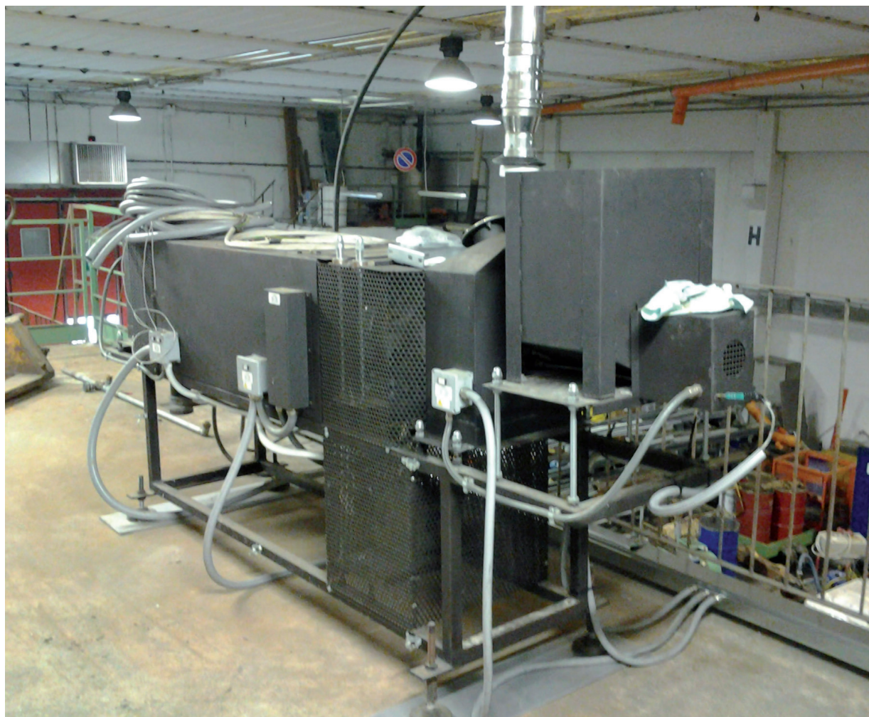
Rotary kiln in scala pilota di Orim per le prove di arrostitimento dei catalizzatori
