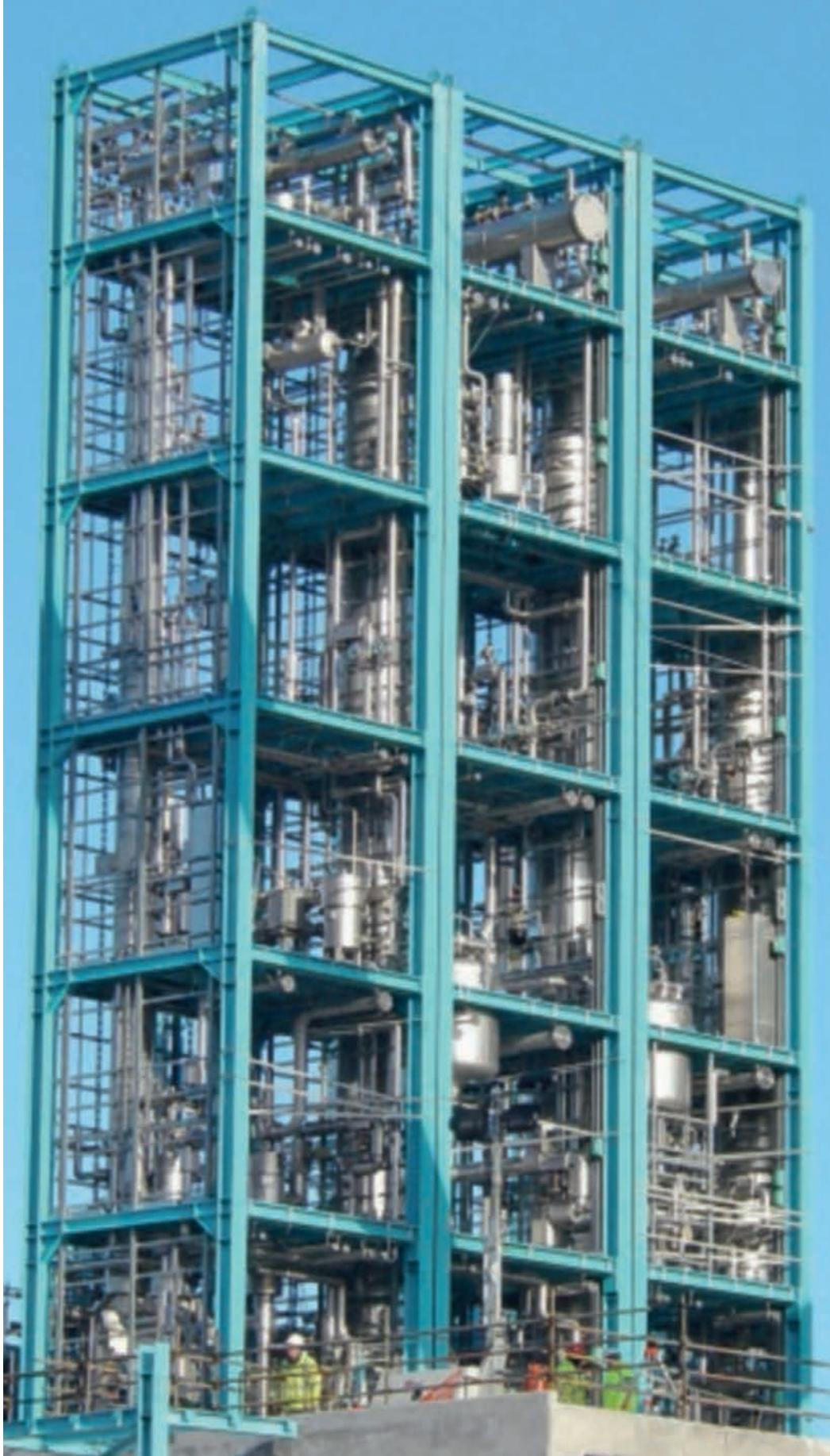
Unità di recupero solvente realizzata da Sulzer con skid completamente preassemblati
