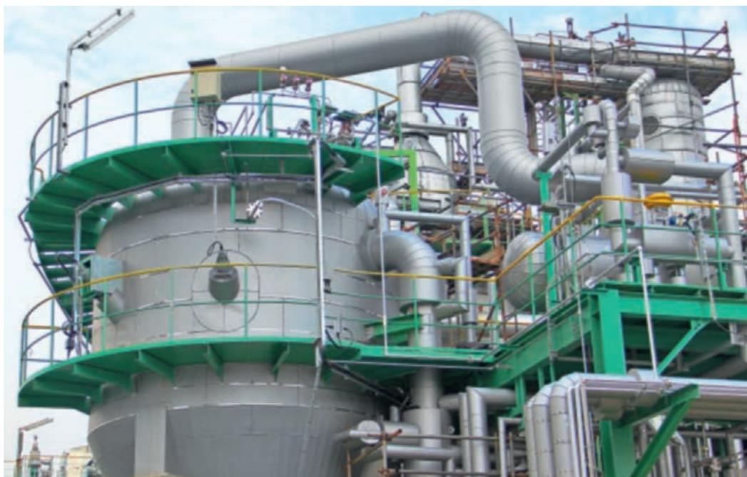
Sulzer ha sviluppato la sua tecnologia di degassaggio dei polimeri per impianti con capacità produttive sino a 200 ktpa
