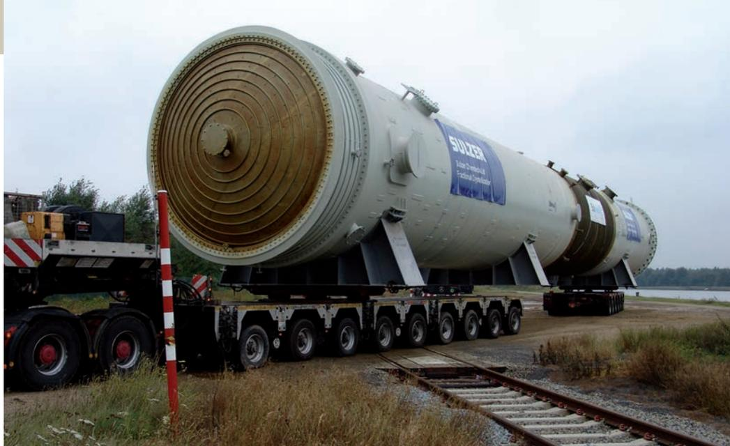
Trasporto di un cristallizzatore a falling film presso il sito produttivo del cliente
