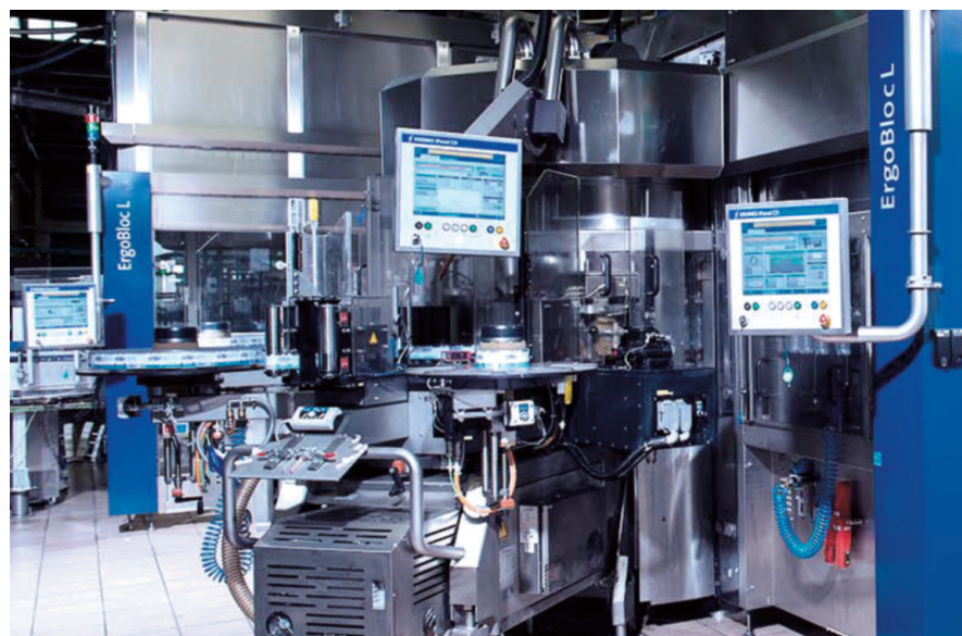
IL PROCESSO ERGOBLOC L DI KRONES INTEGRA LE FUNZIONI DI SOFFIAGGIO, ETICHETTATURA, RIEMPIMENTO E TAPPATURA NELLA PRODUZIONE DI BOTTIGLIE IN PET
